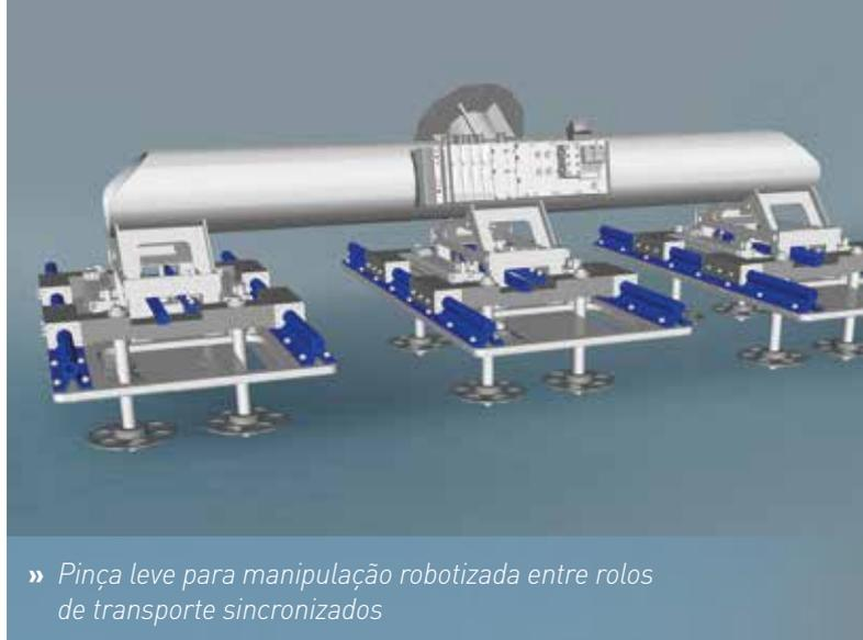
» Pinça leve para manipulação robotizada entre rolos de transporte sincronizados
